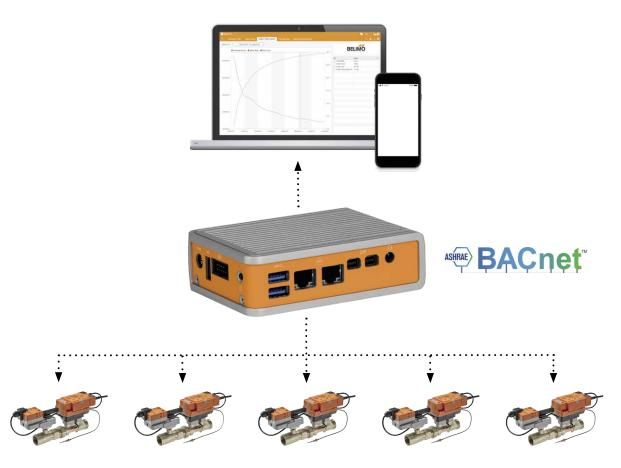
Figure 43: Belimo Clear Edge setup
